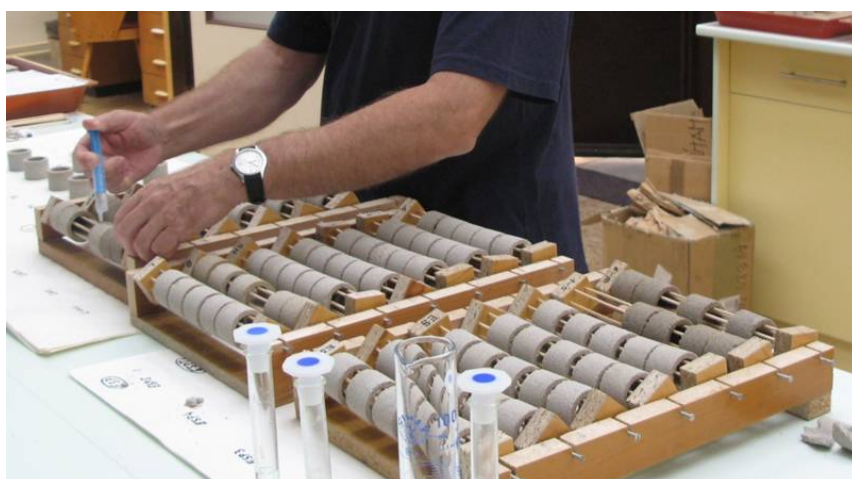
Laboratorní studie zaměřená na posouzení účinnosti vápenné vody jako potenciálního zpevňujícího prostředku historické vápenné omítky.
