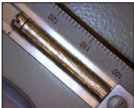
Obr. 7 Nalezený a vyčištěný zářič ^{226}\text{Ra} (A), autoradiograf (B)
