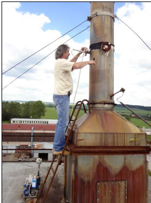
Odběr vzorku z výduchu sušárny uranového koncentrátu
