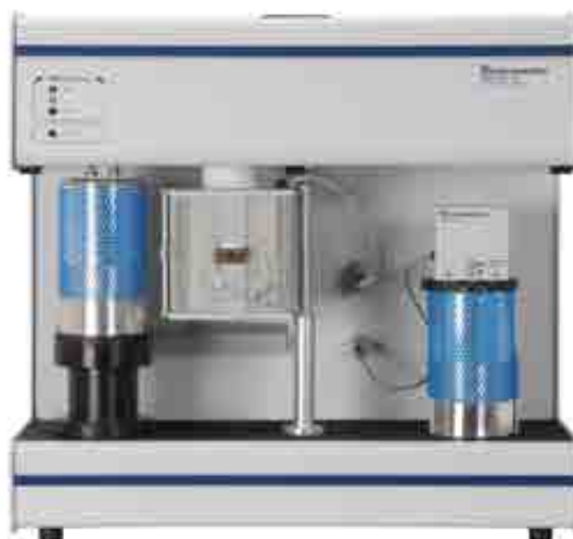
Chemisorpční aparatura, AutoChem 2950 HP, Micromeritics
