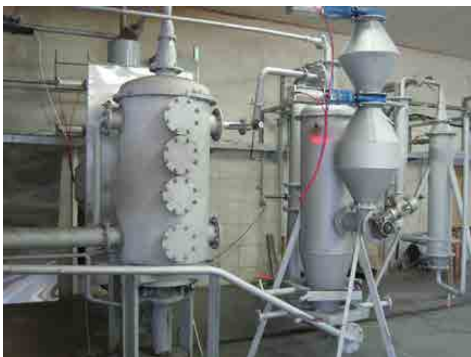
Dvoustupňové uspořádání zplyňovacího reaktoru v testovacím režimu
