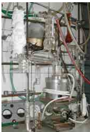
Celoskleněný cirkulační přístroj pro měření RKP
