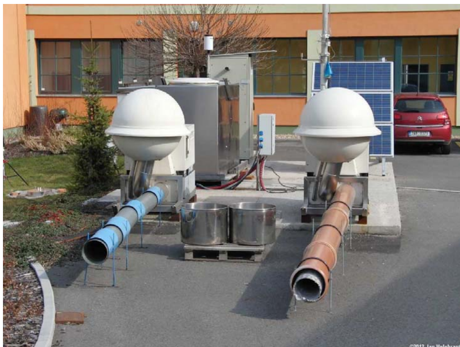
Kontinuální odběr aerosolů a plyných forem jódu v rámci monitorování ovzduší na dvoře areálu SÚRO, v.v.i., Bartoškova
