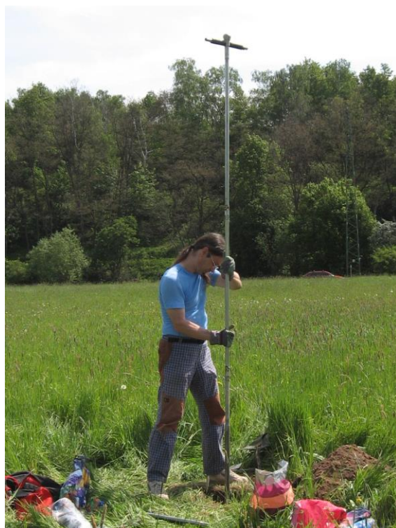
Odběr vzorků ručním vrtákem a ukázka hloubkových profilů Ba, Ni, U a Zn v nivě Ploučnice
