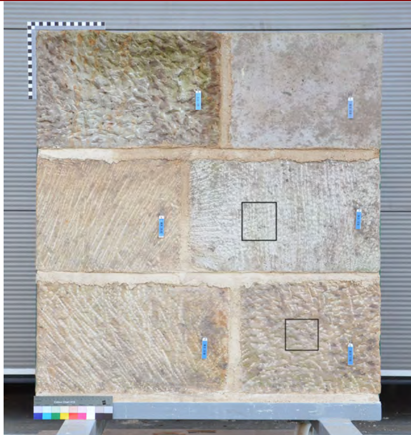
Zkušební bloky s různým způsobem opracování lícních ploch zhotovené pro experimentální potřeby
