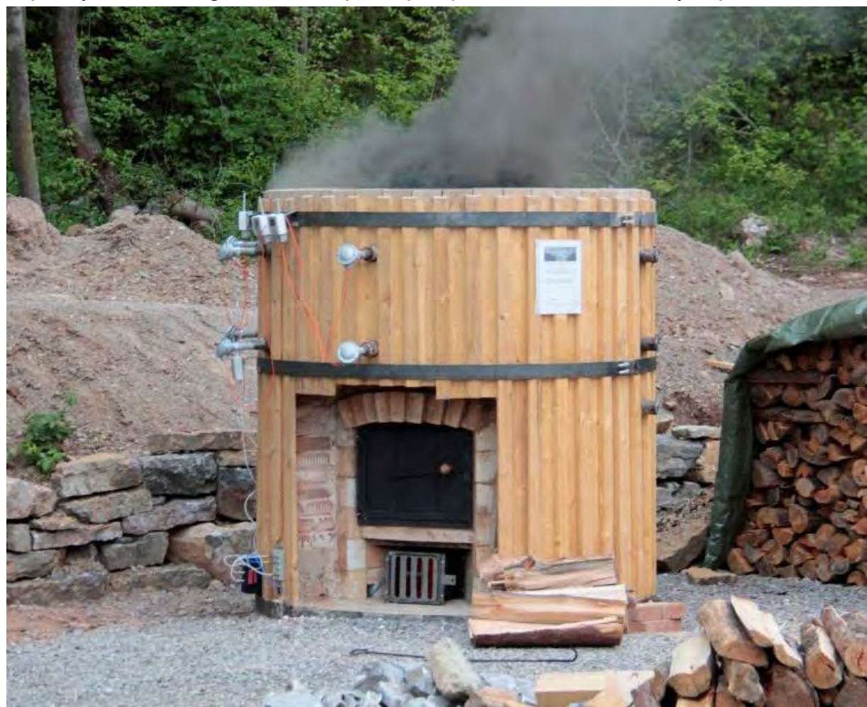
Funkční vzorek vápenné pece pro zakázkovou malovýrobu vápenných pojiv
