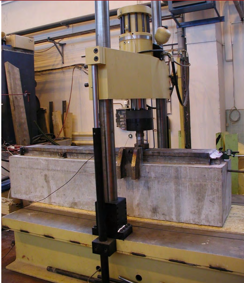
Schéma zatížení zkušební vzorku na zařízení GTM Typ AH 500 - 150 M 161 s kapacitou 500kN, umožňující statické a dynamické zatěžování do 500kN
