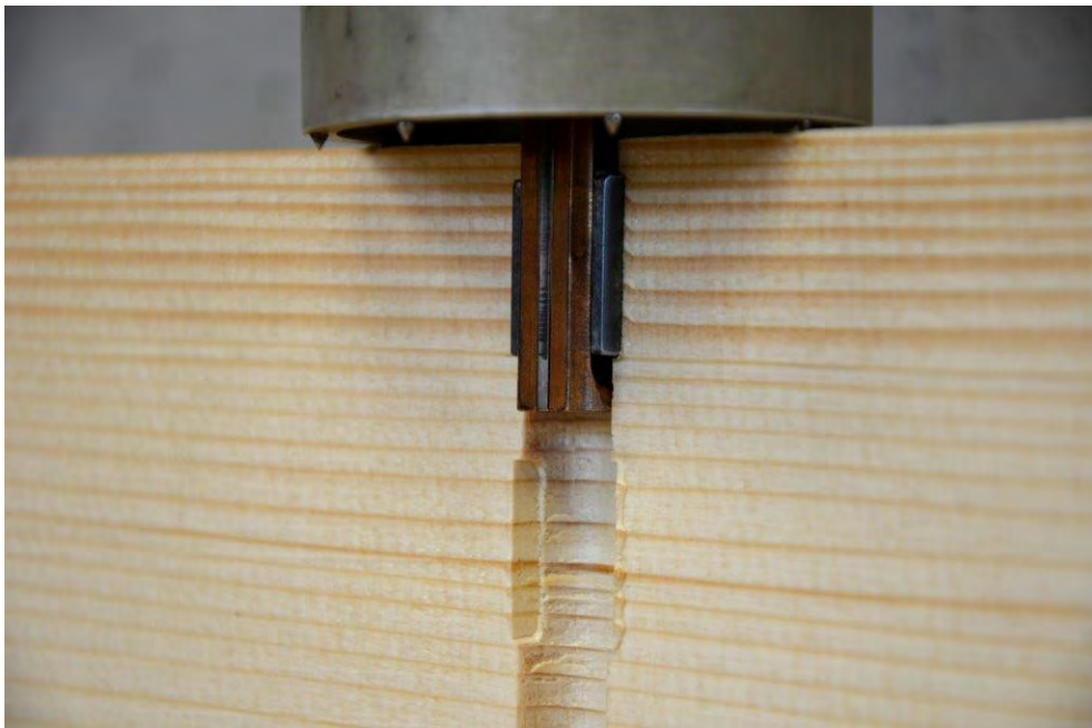
Nová metoda diagnostiky dřeva - roztlačování čelistí ve vrtu
