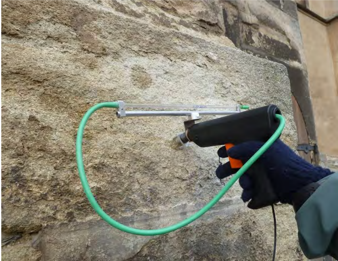
Digitální mikrotrubice pro měření rychlosti průniku vody do materiálu
