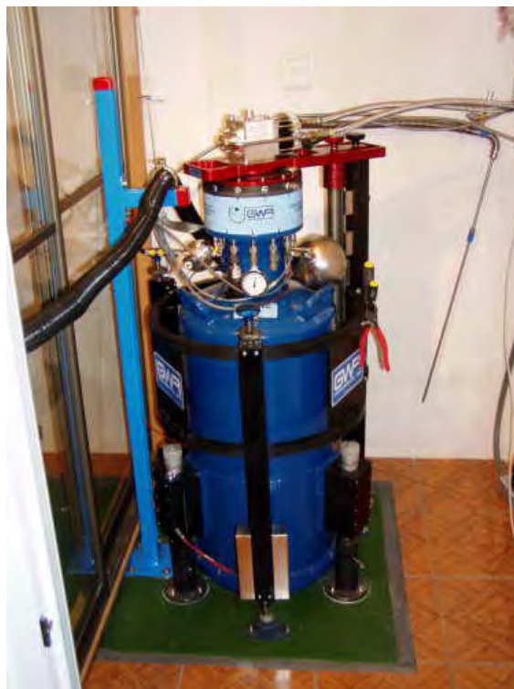
Obr. 10 – Supravodivý gravimetr OSG 050 fy GWR (USA) pro velmi přesné měření variací tíhového zrychlení
