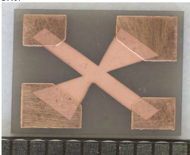
Kovový Halův senzor s měděnou citlivou vrstvou
