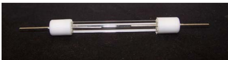
První návrh výbojové cely pro konverzi ^{18}\text{F} na elektrofilní formu.
