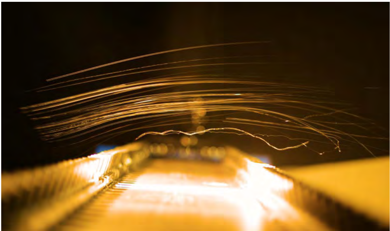
Pohled na mostovku se zábradlím a proudnicemi vzduchu v okolí mostu
