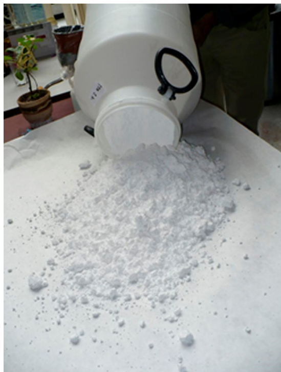
Kyselina tereftalová získaná recyklací odpadních PET lahví pomocí mikrovlnné technologie
