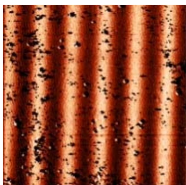
Obr. 1. AFM mapa sinusoidních profilů optické mřížky vytvořených v Pyrexu modulováním iontového toku.
