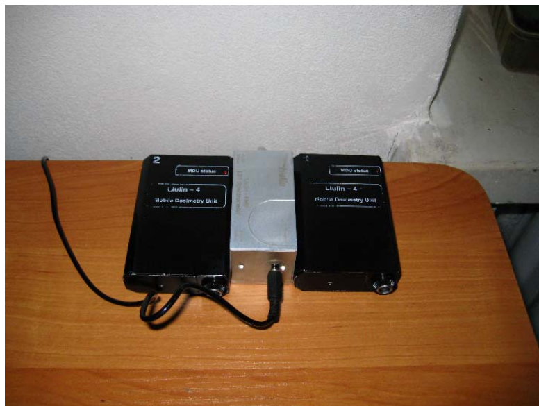
Křemíkové detektory při měření. Liulin-6I (stříbrný) je uprostřed, po stranách dva detektory typu Liulin-4.
