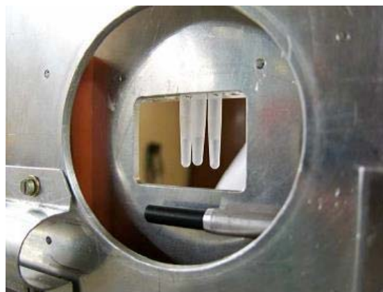
Obr. 2. Ozařování suchých vrstev plasmidové DNA (vlevo) a ve vodných roztocích vybraných vychytávačů volných radikálů (vpravo) na cyklotronu U-120M.
