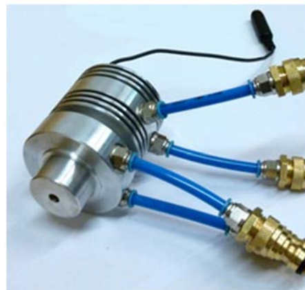
Vodou chlazený terčový systém pro produkci fluorescenčních diamantových nanočástic.
