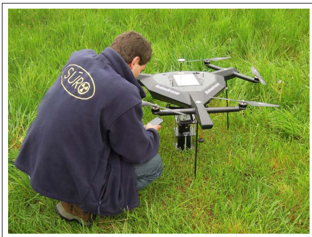
Obrázek 3 SÚRO se podílí na vývoji monitorovacích systémů nové generace pro radiační monitorovací síť včetně využití dálkově ovládaných prostředků (tzv. UAV)
