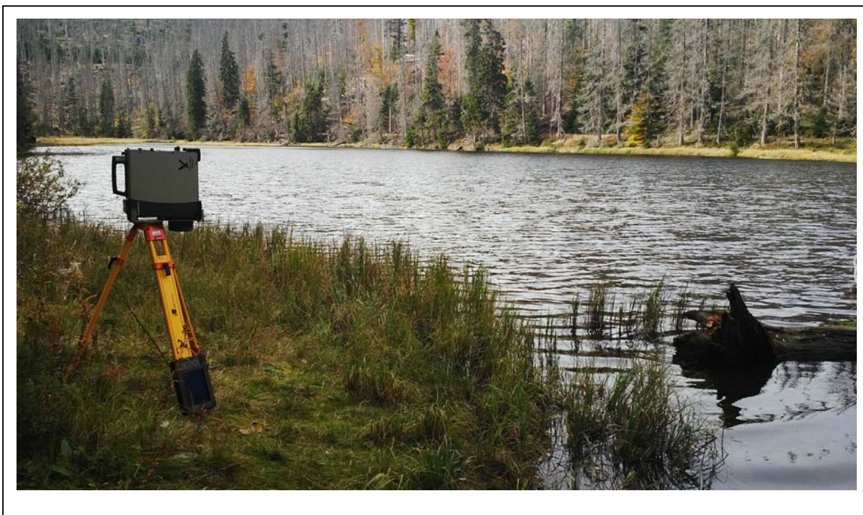
Obrázek 1 Měření plošné aktivity ^{137}\text{Cs} na Šumavě
