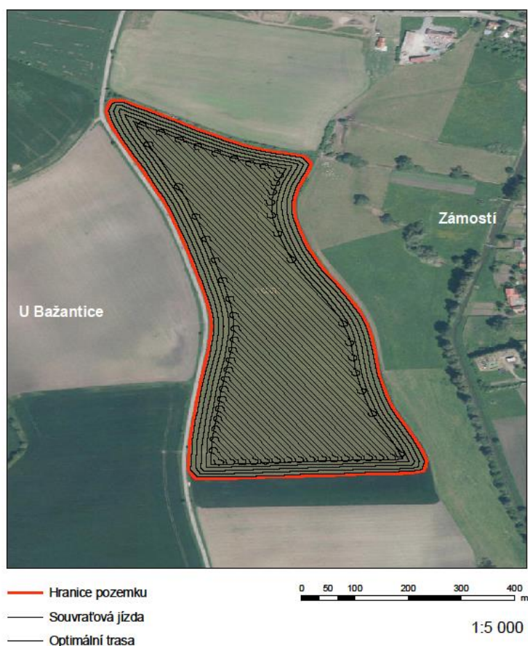
Obr. B4.01: Návrh optimální trasy pohybu strojních souprav
