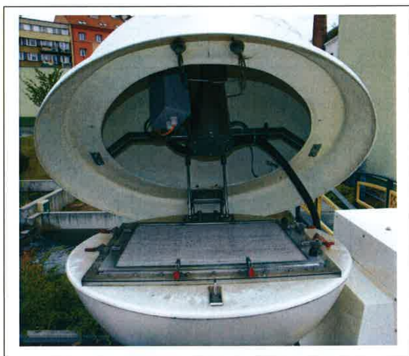
Obr. 5 Modernizované odběrové zařízení Hunter s dálkově ovladatelným průtokem a s online měřením pomocí spektrometrie gama nad filtrem
