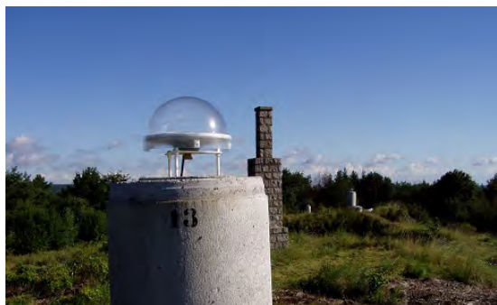
Obr. 9 : Bod č. 13 testovací základny pro ověřování GNSS aparatur
