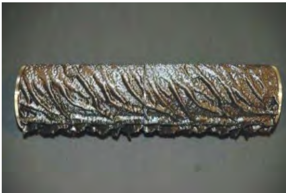
3D model táhla s reprodukovanou námrazou
