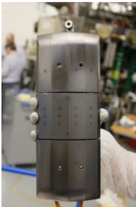
Testovací komponenta první stěny tokamaku COMPASS pro studium toku energie a částic z plazmatu.
