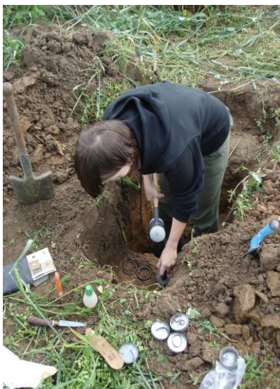
Odběr neporušených půdních vzorků (Kopeckého válečků) pro hodnocení kvality půdy
