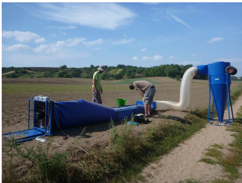
Měření reálné ztráty půdy větrnou erozí větrným tunelem
