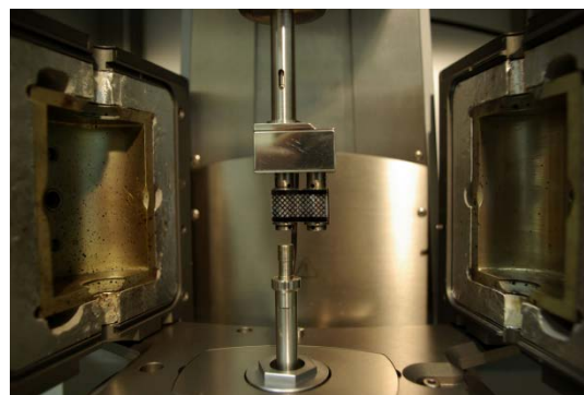
Obr. 4 Měření tahové (elongační) viskozity polymerních tavenin v rotačním reometru pomocí tzv. Sentmanatova extensionálního reometru, jehož výhodou je užití relativně malého objemu měřeného vzorku.
