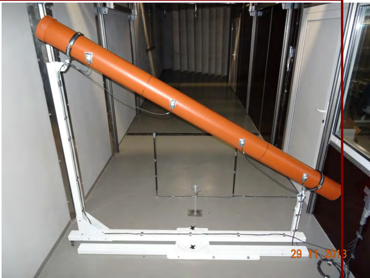
Úsekový model mostního závěsu v klimatické části tunelu před procesem tvorby námrazy.
