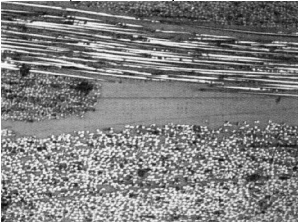
Příčný průřez testovaného laminátu pod mikroskopem.
