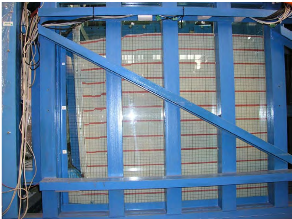
Experiment E8/0,1: Konečný stav deformace a smykových ploch 9.3.2017 po skončení max. aktivního
