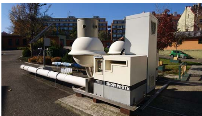
Obrázek 3: Zařízení pro odběr aerosolů „Snow White“ (HPGe detektor je umístěn nad bližší kopulí ve válcové nástavbě)
