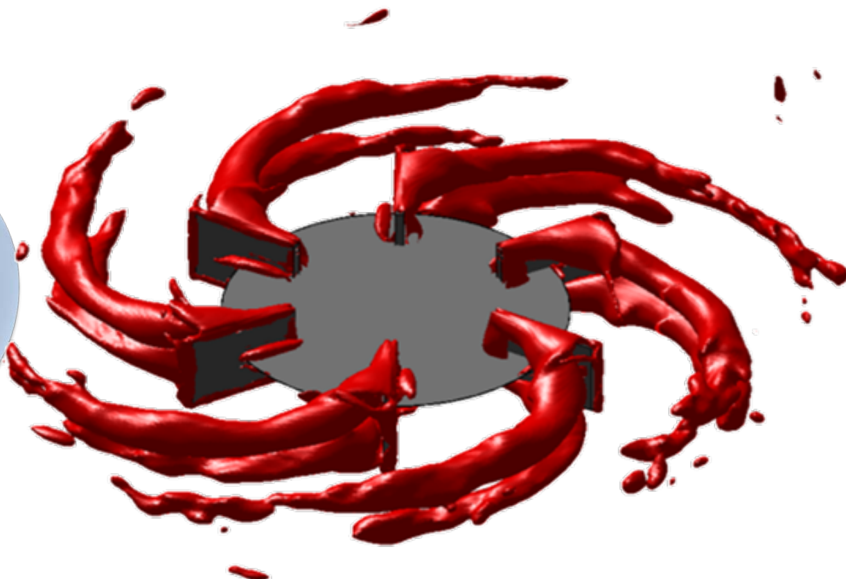
Vírové struktury Rushtonova míchadla určené z \lambda_2 kritéria
