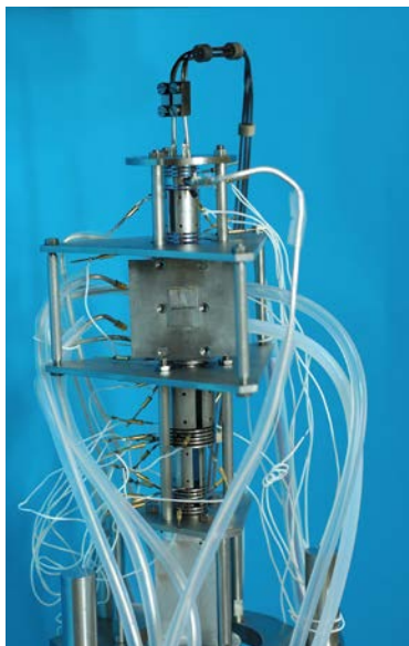
Trochoidální elektronový spektrometr, který slouží k výzkumu nízkoenergetických elektronových srážek
