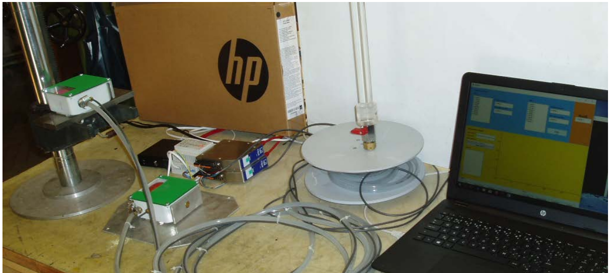
Obr. 8: Foto mobilní soupravy hydrostatické nivelace (2 čidla s napájecím a komunikačním příslušenstvím)
