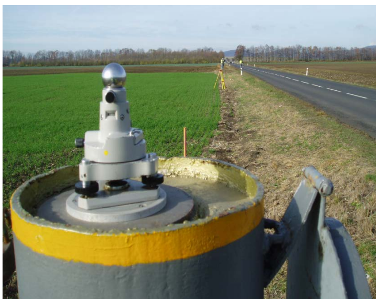
Obr. 7: Měření na státním etalonu
