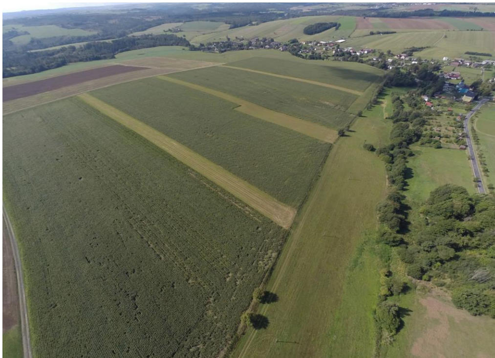
Obr. 21: Realizace zatravněných zasakovacích pásů Větrkovice
