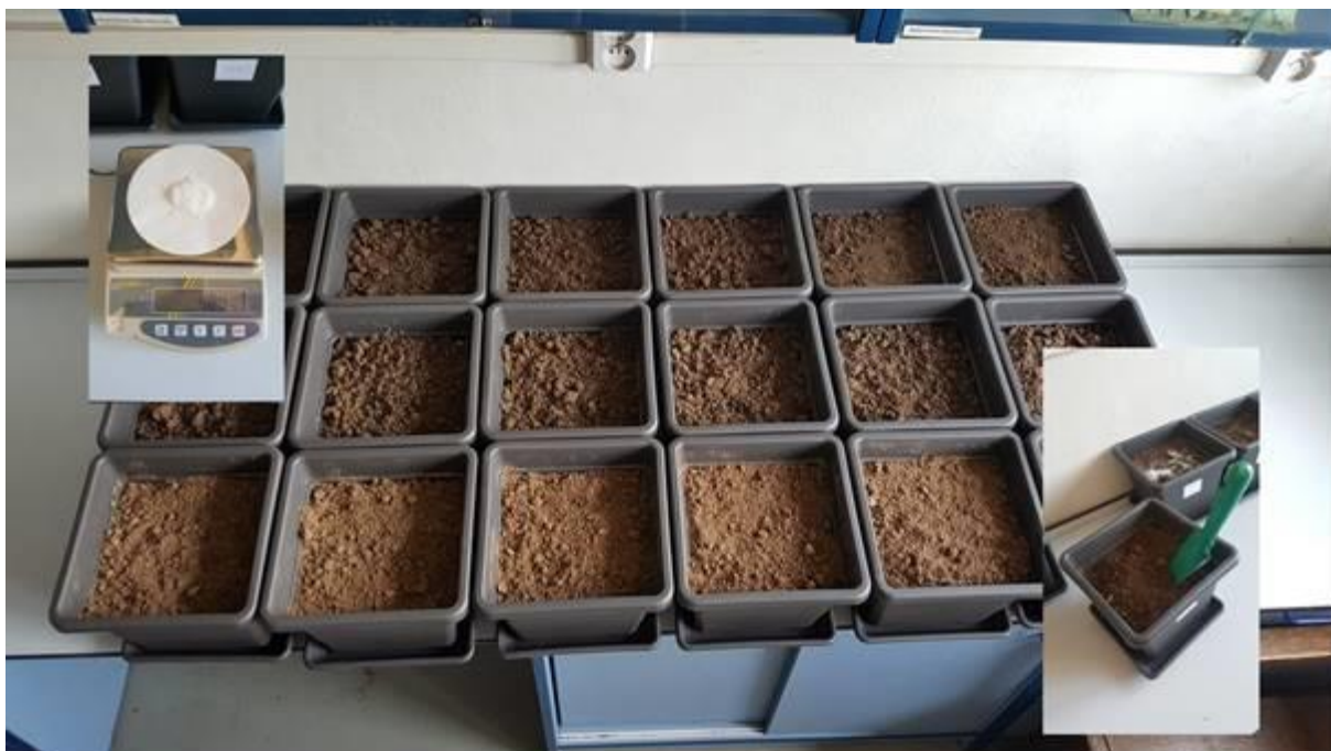
Obr. 7: Aplikace hydrogelů do tří typů zemědělské půdy
