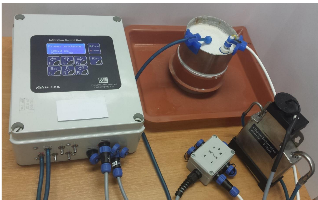
Obr. 15: Demonstrační obrázek uspořádání měřicí soupravy pro laboratorní testování kaolínu Vlevo: terminálová jednotka v provedení s hydraulickým přepínačem dle UV33692, vpravo dole kalibrační jednotka, dole uprostřed kabelová rozbočovač
