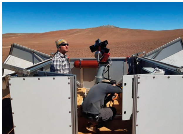
■ Obr. 4 Jeden ze dvou dalekohledů FRAM určených k monitorování stavu atmosféry během jeho instalace v září 2019 vědci z FZÚ v blízkosti budoucí lokality CTA v Chile. V pozadí je Cerro Paranal, kde je umístěn Very Large Telescope organizace ESO, jeden z předních astronomických přístrojů současnosti.
