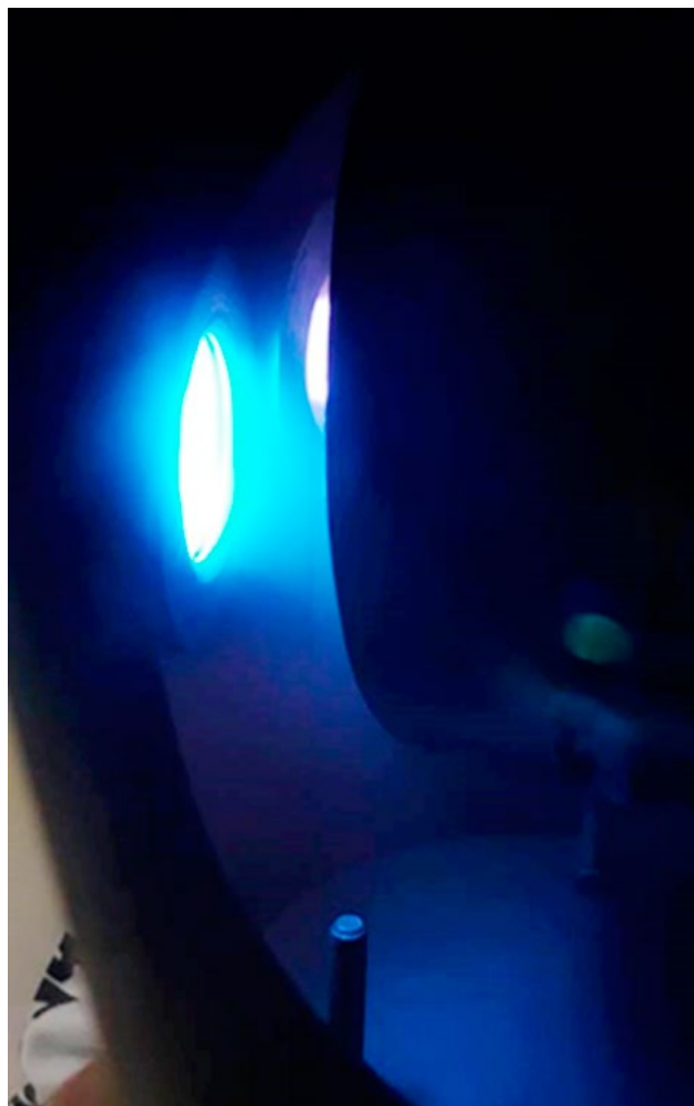
■ Obr. 79 Fotografie pulzního plazmatu generovaném v hybridním systému HiPIMS+RF ECWR.
