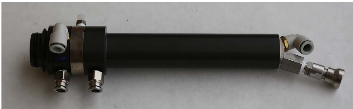
Nový plynový střednětlaký terč pro přípravu ^{83}\text{Rb} .
