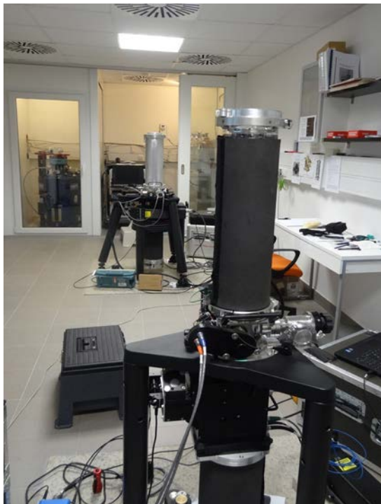
Obr. 6. Státní etalony tíhového zrychlení, gravimetry FG5X-251/HS5 a FG5-215/HS5.
