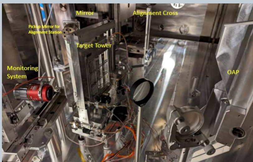
Obr. 2.6.2 Interakční oblast laseru s plazmatem ve vakuové komoře ELIMAIA.
