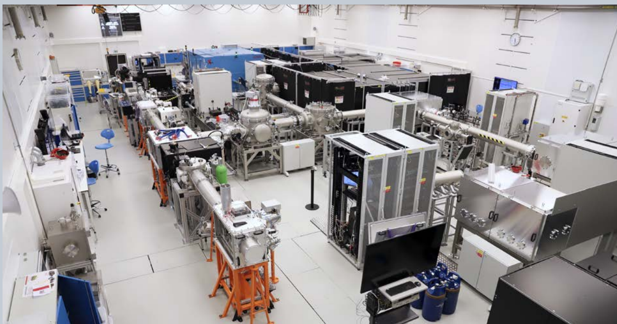
Obr. 2.6.3 Experimentální hala E1. Vlevo je beamline pro XUV se zdrojem HHG a koncovými stanicemi XUV; komora MAC pro AMO a koherentní difrakční zobrazování a VUV elipsometr. Uprostřed je beamline pro tvrdé rentgenové záření s plazmovým RTG zdrojem s měděnou páskou a stanicí TREX pro rentgenovou difrakci a spektroskopii. Napravo jsou stanice pro optickou spektroskopii; trELIPS, IR spektroskopii a TCT.
