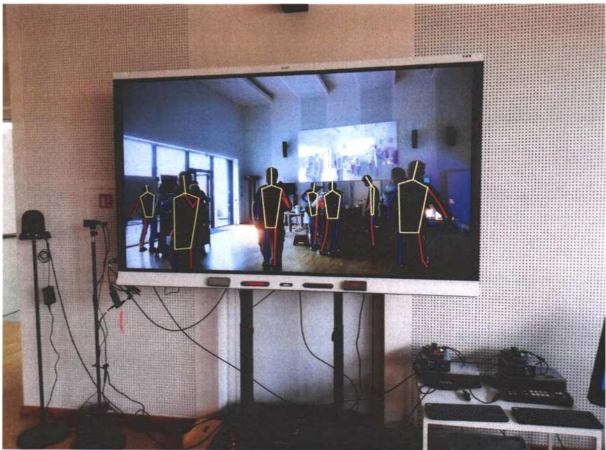
Obr. 6: Systém navržený a realizovaný v ÚTIA byl využit ve FZU během noci vědců pro demonstraci HW akcelerace neuronové sítě movenet v reálném čase s video vstupem a výstupem v plném rozlišení.
