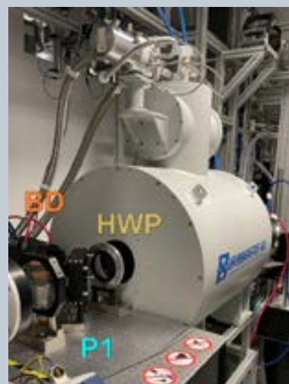
Obr. 2.5.1 Testování dlouhodobé stability a izolačního poměru Faradayova rotátoru (vlevo) spolu s fotografií zařízení v laboratoři centra HiLASE (vpravo). Převzato z [1].
