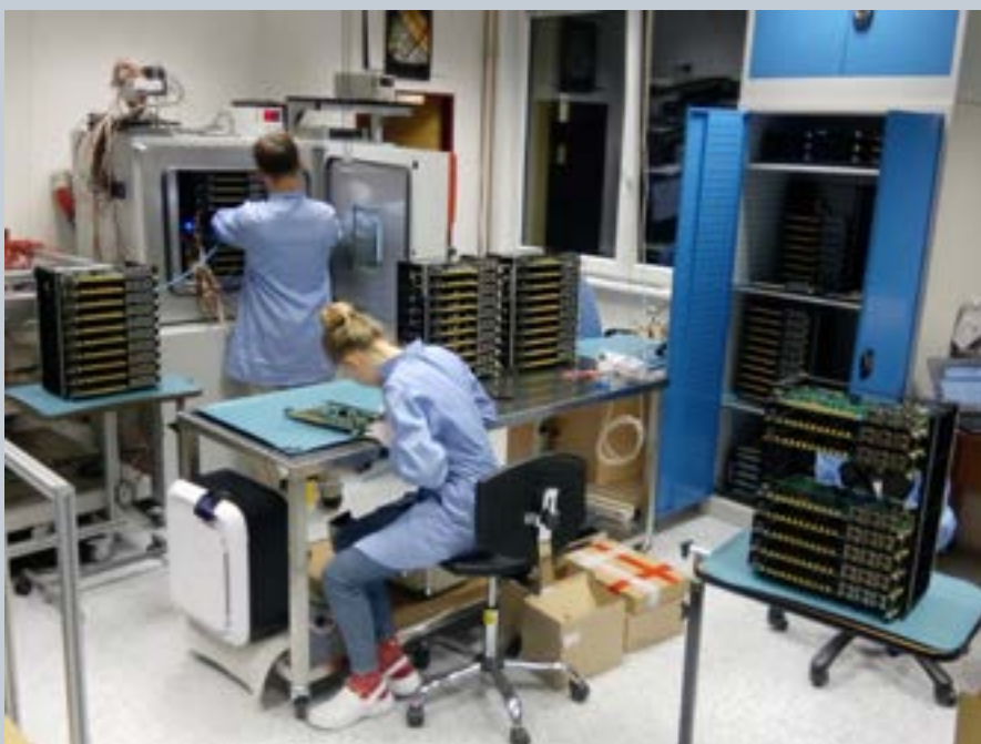
Obr. 2.1.1 M. Kubátová a P. Tobiška při práci v Laboratoři astročásticové fyziky během testování modulů nové elektroniky pro Observatoř Pierra Augera.
