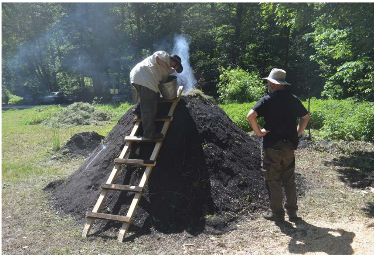
Rekonstrukce výroby dřevěného uhlí ve Staré huti u Adamova
