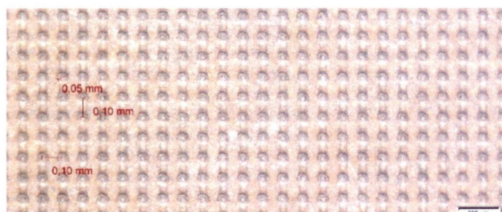
Obr. 14: Mikrostrukturovaný povrch korozivzdorné (austenické) oceli.
