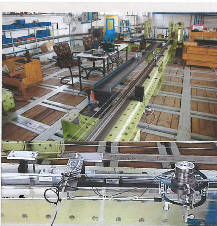
Experimentální sestava pro nepřímé měření frekvence: ocelový zkušební nosník (vrchní snímek); řízené zkušební vozidlo (dolní snímek). Obrázek ukazuje uspořádání systému interakce vozidlo-most v laboratoři ÚTAM AV ČR. Testovací vozidlo obsahuje pružnou jednotku s možností nastavení vertikální frekvence. Nosníky jsou připevněny k U-rámu, který se otáčí, což umožňuje upravit tuhost podpory a vertikální frekvenci vozidla. Pružná jednotka slouží jako pohyblivý detektor, který zaznamenává odezvu testovacího nosníku.
