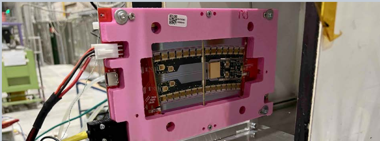
Obr. 2.1.3 Křemíkový stripový modul typu R3 endcap vyvinutý kolaborací ATLAS Inner Tracker během jeho testování vysokoenergetickými svazky nabitých hadronů v CERN SPS testbeam facility.
