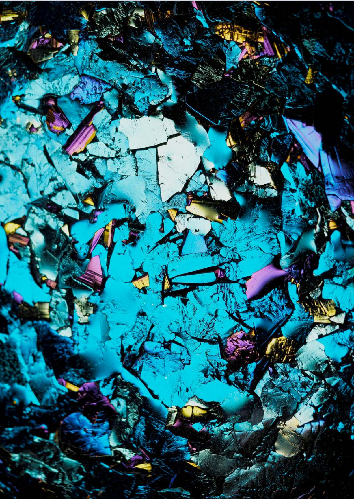
Krystalický karbid křemíku (SiC) pěstovaný sublimační metodou na grafitové zárodečné desce. Foto: Adam Lorenc, FJFI ČVUT, soutěž Fyzikální fotografie 2025 (1. místo, kategorie studentů SŠ a VŠ).
