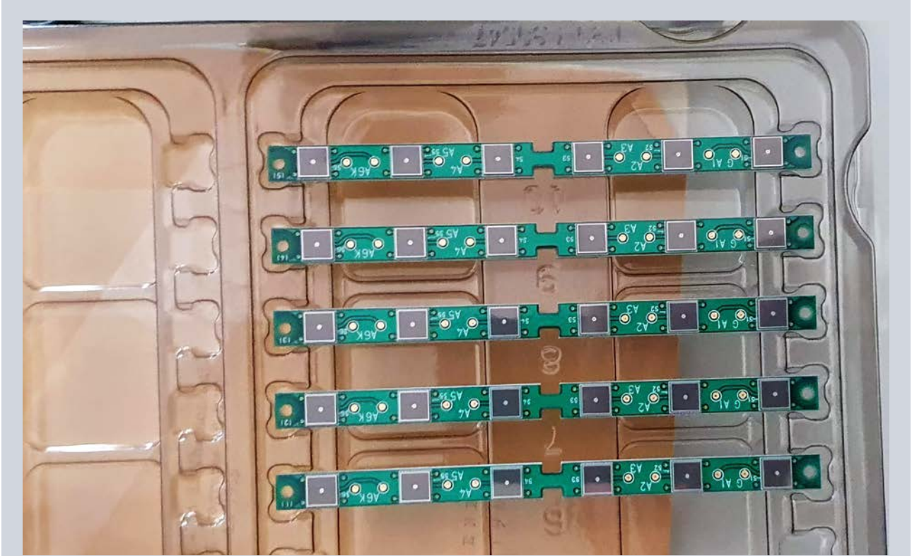
Obr. 2.1.4 Křemíkové fotonásobiče (SiPM) jsou fotocitlivé polovodičové diody připravené k testování v kryogenní laboratoři FZU AV ČR. Testy probíhají jak při pokojové teplotě, tak při velmi nízkých teplotách, kdy jsou detektory ponořeny do Dewarovy nádoby s kapalným dusíkem (77 K / -196 °C). Během zkoušek musí SiPM absolvovat tři tepelné cykly opakovaného ponoření a vynoření. Po celou dobu testování nesmí dojít k jejich mechanickému ani elektrickému poškození ani ke ztrátě definovaných vlastností.
