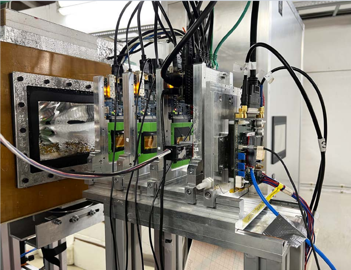
Obr. 2.1.3 Chladicí box vyvinutý ve FZU obsahující ATLAS Inner Tracker stripový křemíkový detektor, připravený k testování pomocí svazku elektronů o energii 5 GeV DESY II Test Beam Facility v německém Hamburku. Tři pixelové detektory typu ALPIDE (se světle zelenými rámečky) tvoří polovinu teleskopu ALPIDE, systému sloužícího k rekonstrukci trajektorií prolétajících urychlených elektronů. V přední části je umístěn pixelový detektor typu TelePix, který se používá k určení detekční účinnosti studovaného stripového detektoru. FZU se již více než deset let podílí na test beam kampaních stripové části projektu ATLAS Inner Tracker, a to jak personálně, tak zajištěním experimentálního vybavení. V rámci těchto aktivit bylo vyvinuto a vyrobeno široké spektrum nezbytné infrastruktury, včetně motorizovaného polohovacího systému pro přesné umístění testovaného detektoru do svazku částic a chladicího systému umožňujícího řízení teploty detektoru během měření.
