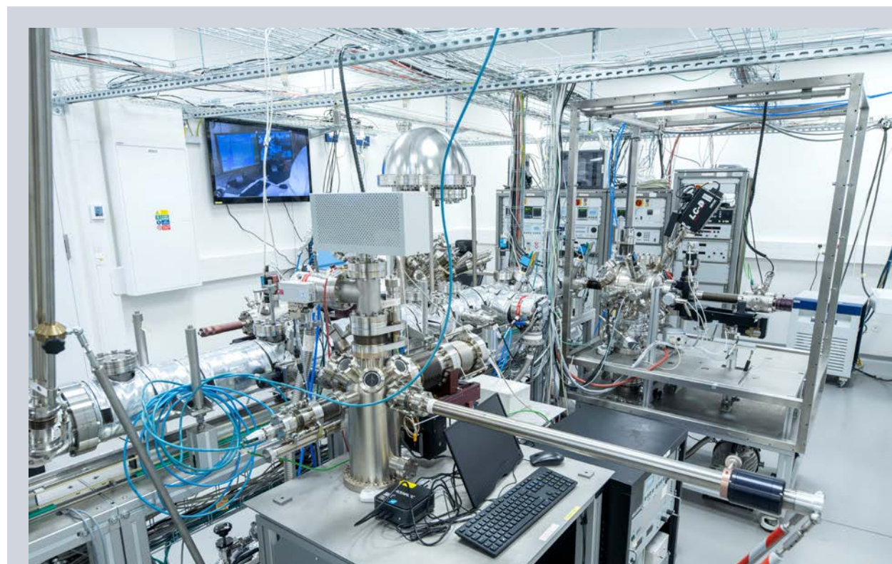
Obr. 2.2.1 Nově instalovaná laboratoř SSLS v budově SOLID21. Na obrázku je vidět několik depozičních komor a různých analytických zařízení. Foto: Josef Landergott, AV ČR.
