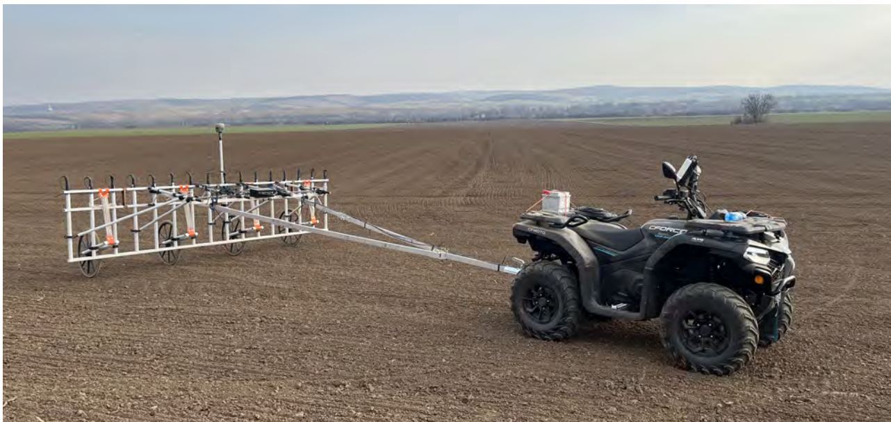
Sestavené zařízení Magneto MX V3 s 16sondovým gradiometrem pro geofyzikální měření. Foto D. Cibulka.
