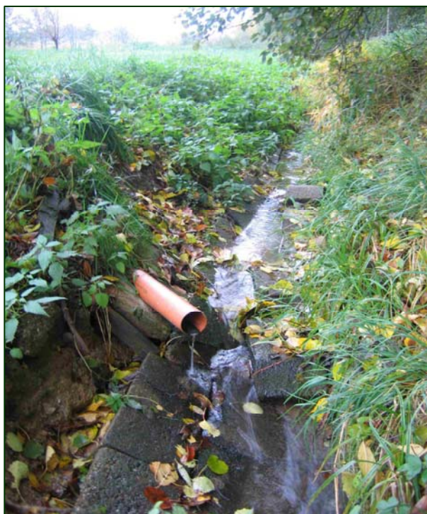
Obr. 5. Výtok drenážní vody z biofiltru s nízkým obsahem dusičnanů v pokusném povodí Černičí po dvou letech zkoušení (říjen 2007).
