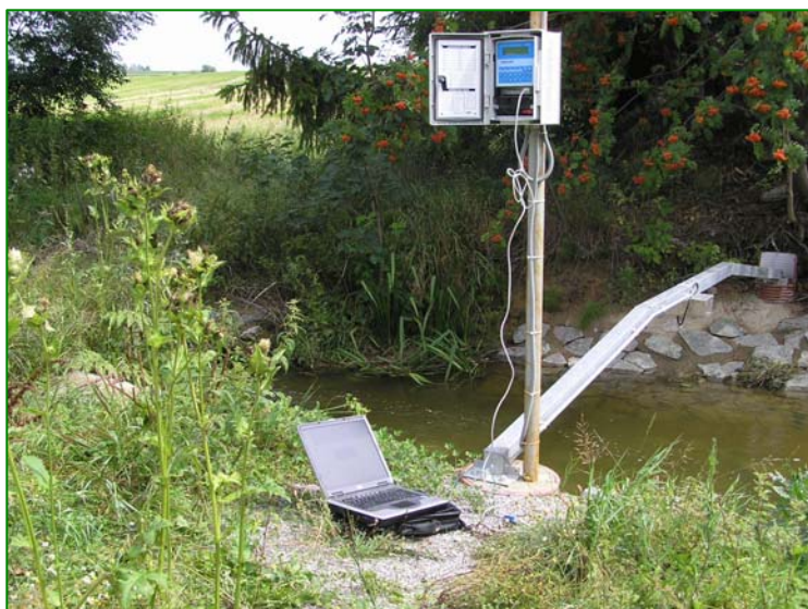
Obr. 25. Měření průtoků a transportu plavenin na experimentálním povodí Němčický potok.
