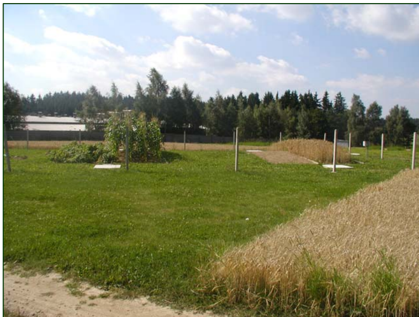
Obr. 8. Měření odtoků a smyvů půdy z atmosférických srážek na experimentální stanici MZLU ve Vatině.
