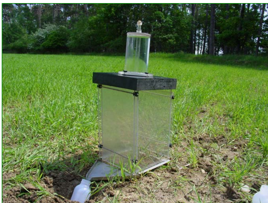
Obr. 24. Simulátor deště dle Kamphorsta.
