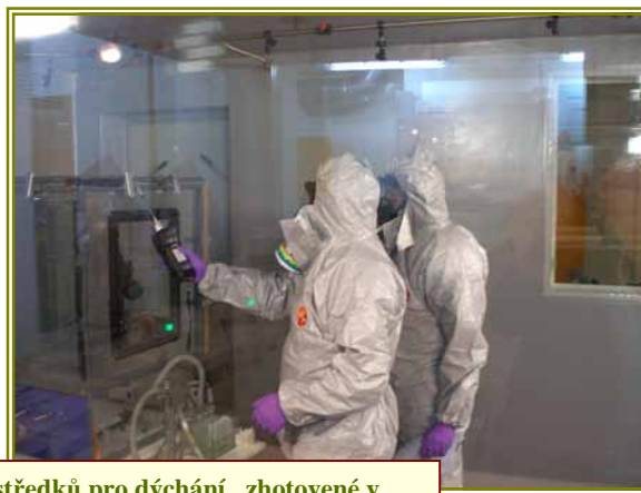
Zařízení na testování ochranných prostředků pro dýchání, zhotovené v SÚJCHBO, v.v.i. a testování v toxikologické komoře
