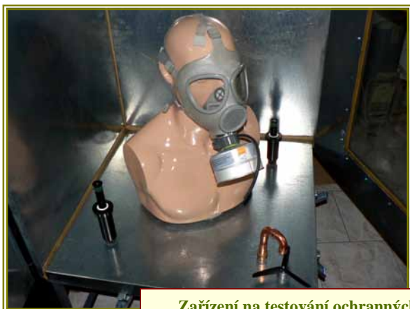
Zařízení na testování ochranných prostředků pro dýchání, zhotovené v SÚJCHBO, v.v.i. a testování v toxikologické komoře
