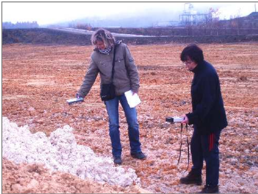
Měření dávkového příkonu uranových kalů na odkališti o.z. TÚU, s. p. DIAMO Stráž p.R.
