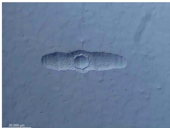
■ Obr. 7 Nomarského (DIC – Differential Interference Contrast) mikrofotografie ablačního otisku svazku rentgenového laseru LCLS v monokrystalickém wolframu olovnatém. Dobře jsou patrné dva prahy: na periferii kráteru jsou ostré kontury neteplné ablace a ve střední části kráteru pak tavení, zčásti ovlivněné termalizovanou frakcí energie při vyšších fluencích. Připomeňme, že optické lasery způsobují nejprve tepelné tavení a až na úrovni vyšších fluencí vyvolávají neteplnou ablaci.
