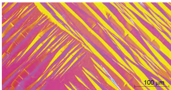
■ Obr. 9 Tenký film (tloušťka 500nm) se strukturou nemodulovaného martensitu –NM. Délka delší strany okolo 0,5 mm. Větvení je dobře patrné na rozhraní různě orientovaných lamel. Kontrast se objevuje díky Nomarského kontrastu (DIC), který zviditelňuje různě nakloněné plochy.
