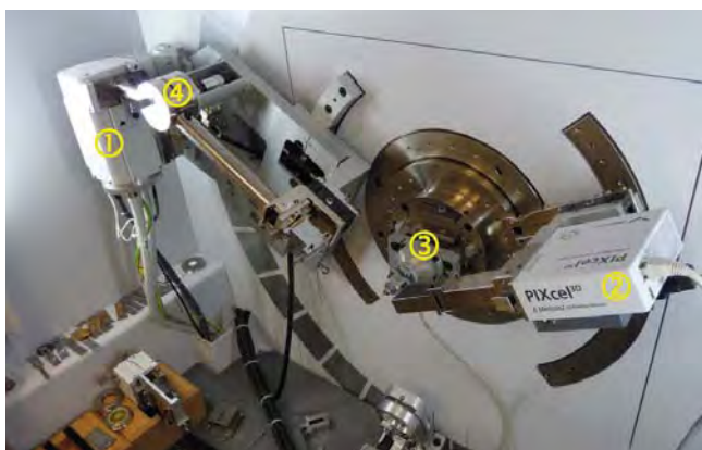
■ Obr. 5 Difraktometr Empyrean. (1) zdroj rentgenova záření; (2) detektor; (3) držák vzorku; (4) Johanssonův symetrický monochromátor
