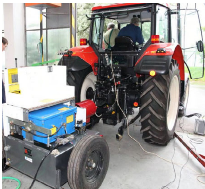
Obr.12.1 Měření výkonových, energetických a emisních parametrů traktorů
