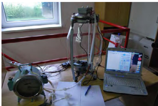
Obr. 6.1 Měřicí zařízení pro ověření reakce O 3 – NH 3
