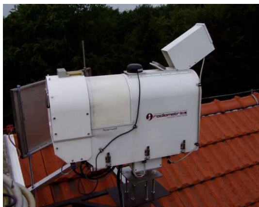
obr. 11 - Radiometr na měření obsahu vodních par v atmosféře
