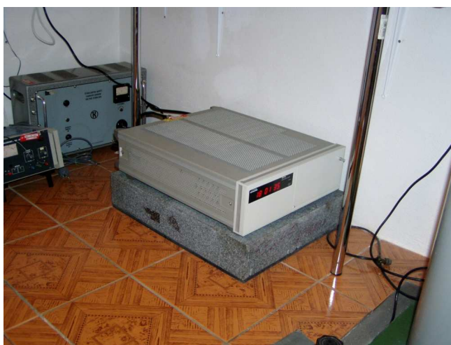
Obr. 10 - Standard času - Cesiové atomové hodiny Symmetricom 5071A
