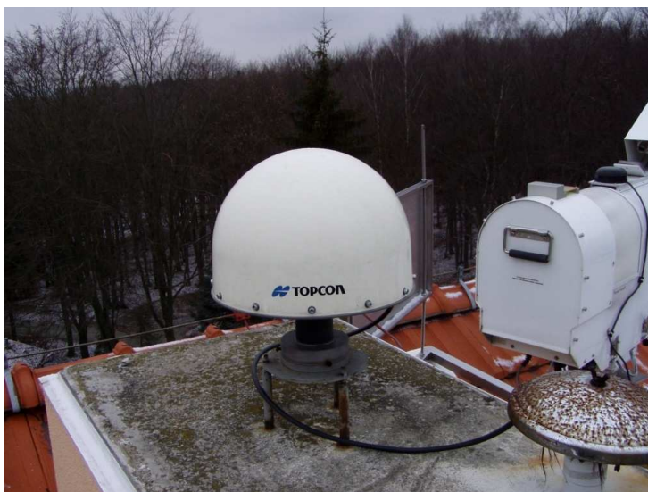
Obr. 7 - Permanентní stanice technologie GNSS, bod GOPE
