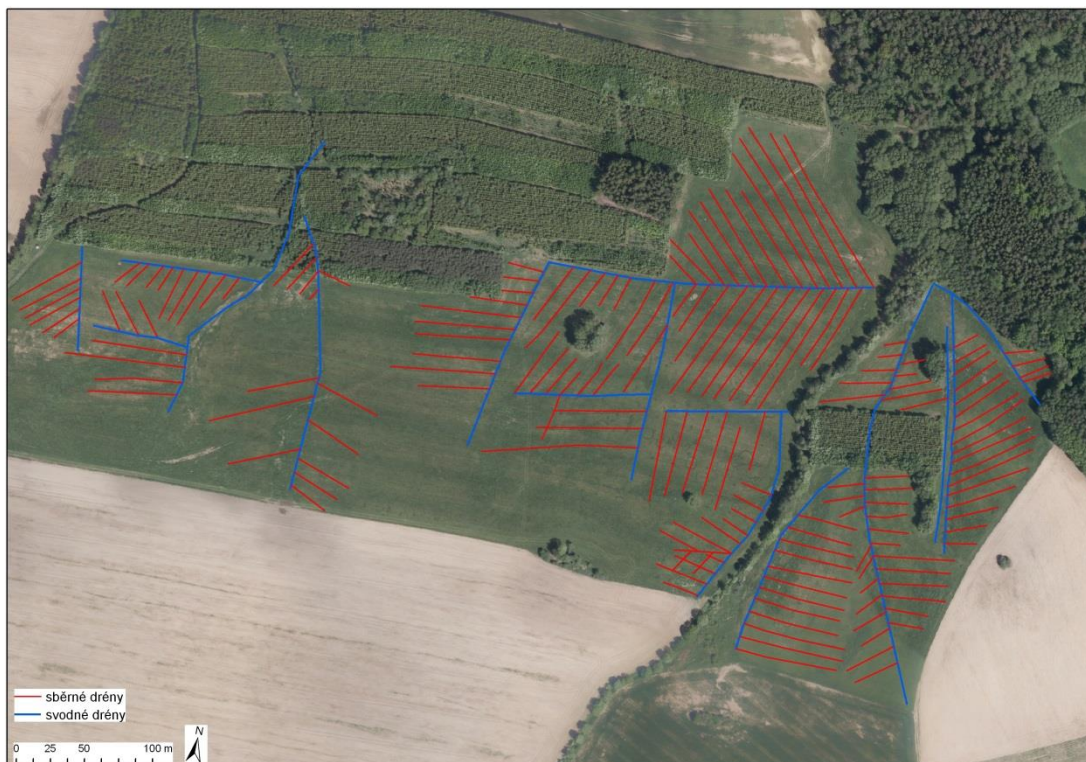
Obr. č. 1: Ukázka drenážního systému identifikovaného z materiálu DPZ (18. 5. 2012, trvalý travní porost, lokalita Žejbro, okres Chrudim)
