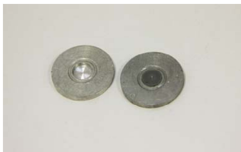
Terč z obohaceného molybdenu-100 pro přípravu technecia-99m v hliníkovém držáku a prázdný hliníkový držák po rozpuštění terče.
