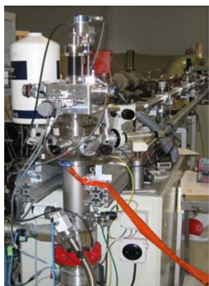
Obr. 3. Iontový mikrosvazek u urychlovače Tandetron.
