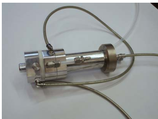
Obr. 1. Plynový terč pro přípravu radionuklidu ^{83}\text{Rb} .
