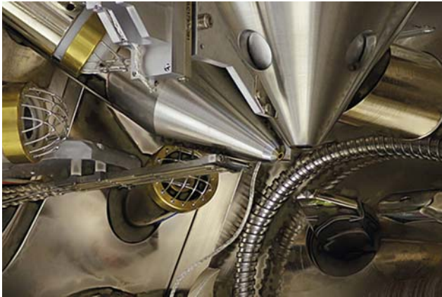
■ Obr. 1 Pohled do komory elektronového mikroskopu Fera 3. Přístroj FIB+SEM v laboratoři elektronové mikroskopie.
