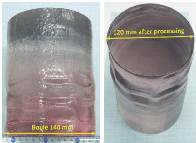
■ Obr. 4 Laserové krystaly Yb dopovaného YAG krystalu (úroveň dopování 2%) o průměru 14 cm, vypěstované technologií vyvinutou ve spolupráci FZÚ a firmy Crytur (na technologii je podána patentová přihláška). Jde o největší YAG monokrystaly tohoto typu ve světě.
