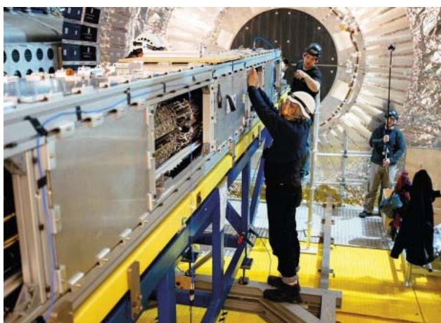
Obr. 1 Pracovníci Fyzikálního ústavu Michal Tomášek a Jan Mládek při přípravě pixelového detektoru v šachtě experimentu ATLAS.
