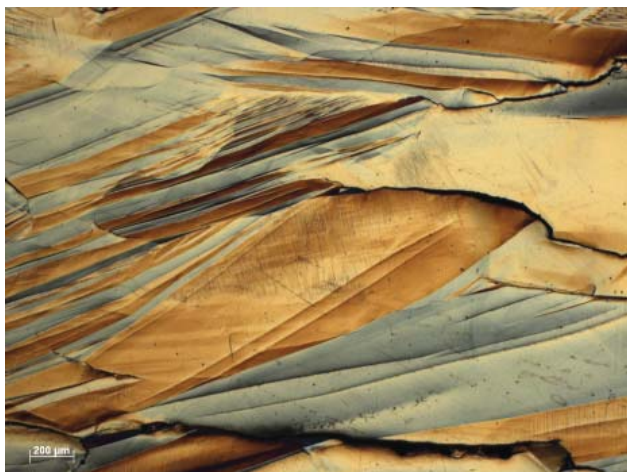
■ Obr. 13 Martenzitické ferroelastické domény (různé barvy odpovídají různému náklonu povrchu, černé náhodně křivé čáry jsou hranice zrn). Pozorování provedeno v optickém mikroskopu pomocí Nomarského kontrastu.
