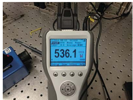
■ Obr. 6 Výstupní výkon a účinnost v základním prostorovém módu na výstupu druhého stupně Beamline C v kontinuálním režimu (nahore). Podarilo se stabilně generovat >500 W, čímž jsme prokázali schopnost komponent pracovat v systému s vysokým středním výkonem.
