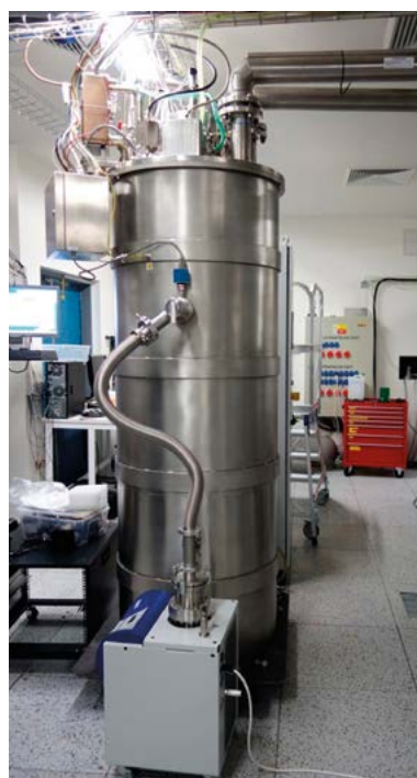
■ Obr. 7 Zdokonalený systém Braytonova chladicího cyklu pro laser L2, zahrnující kromě vysokotlačkového kompresoru a expandéru kaskádu 7 tepelných výměníků a umožňující provozovat systém L2 na teplotě 130 K.
