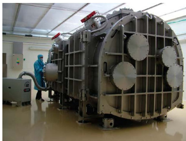
■ Obr. 10 Komora kompresoru pulsů L3 během vakuových zkoušek v testovacích čistých prostorách Delong Instruments.
