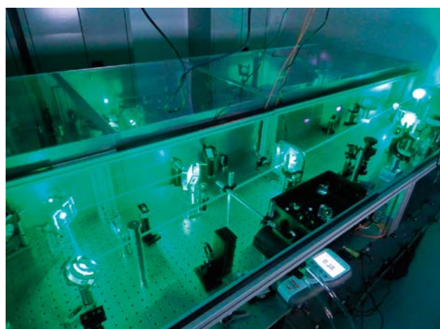
■ Obr. 4 Pohled na čtvrtý OPCPA zesilovač (uprostřed) čerpaný pikosekundovými pulsy na vlnové délce 515 nm (zelený svazek). V horní části je vidět mřížkový pikosekundový kompresor čerpacího laseru (1030 nm) a krystal pro generaci druhé harmonické frekvence (515 nm).
