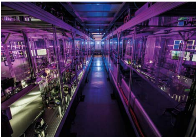
■ Obr. 8 Integrovaný laserový řetězec L3-HAPLS ve vývojové laboratoři Lawrence Livermore National Laboratory. Na levé straně snímku je diodově buzený výkonový čerpací systém, na pravé straně se nachází čelo femtosekundového řetězce. Diagnostický systém výstupních pulsů je umístěn na optické lavici nacházející se ve vzdáleném konci snímku.
