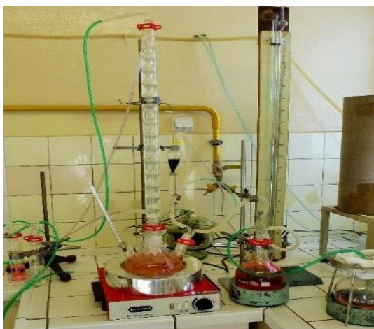
Cirkulační aparatura pro analýzy ^{14}\text{C} ve vzorcích vody kapalných výpustí.
